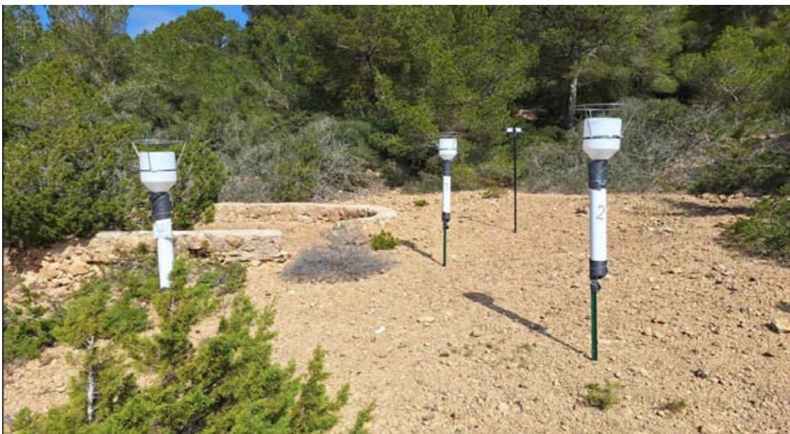
EFE-5. Colectores de depósito atmosférico y dosímetros pasivos en la isla de Cabrera
