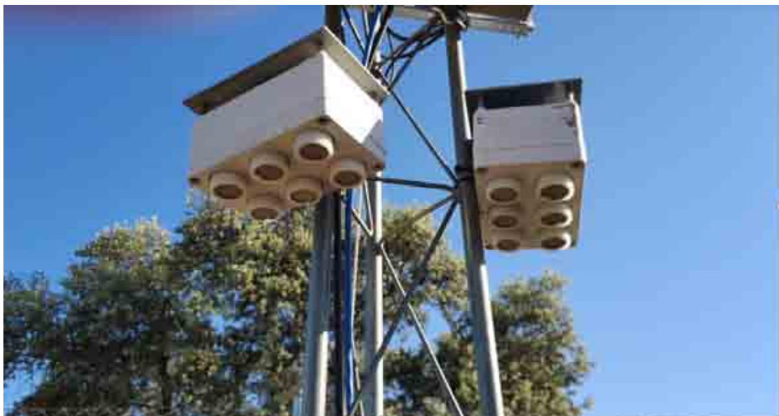
EFE-13. Dosímetros pasivos utilizados en las parcelas de Nivel II del ICP-Forests
