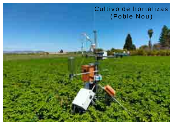
EFE-1. Estaciones de medidas de flujos de \text{CO}_2 y \text{H}_2\text{O} operadas por la Fundación CEAM en 2023.
