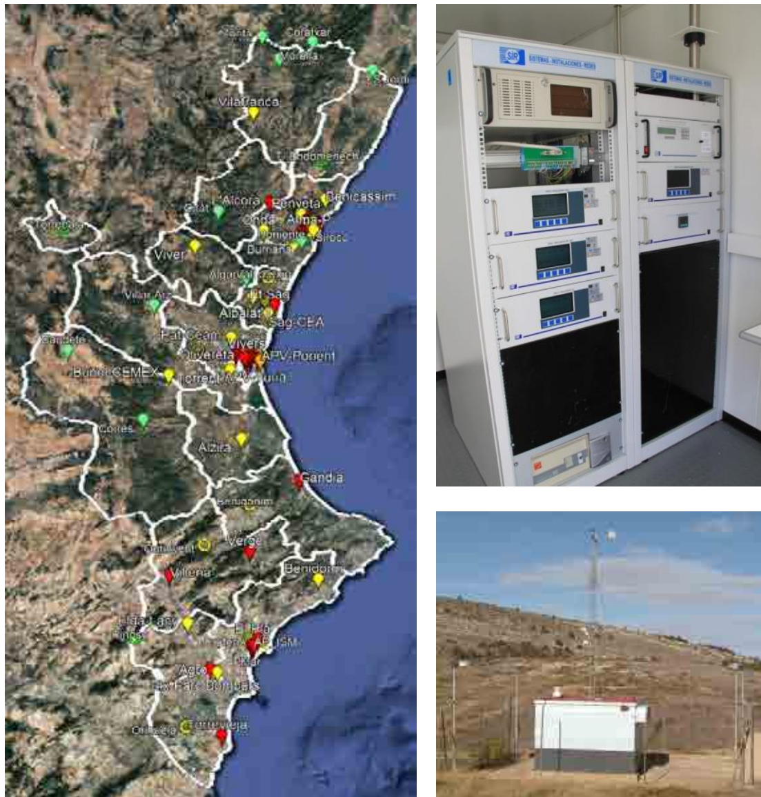
Figura DIN-1. Distribución de estaciones de la RVVCCA en 2023, y aspecto interior y exterior de una estación de calidad del aire. Leyenda: Urbanas (Rojo), Suburbanas (Amarillo), Rurales (verde)
