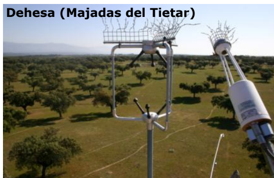
EFE-1. Estaciones de medidas de flujos de CO 2 y H 2 O operadas por la Fundación CEAM en 2022.
