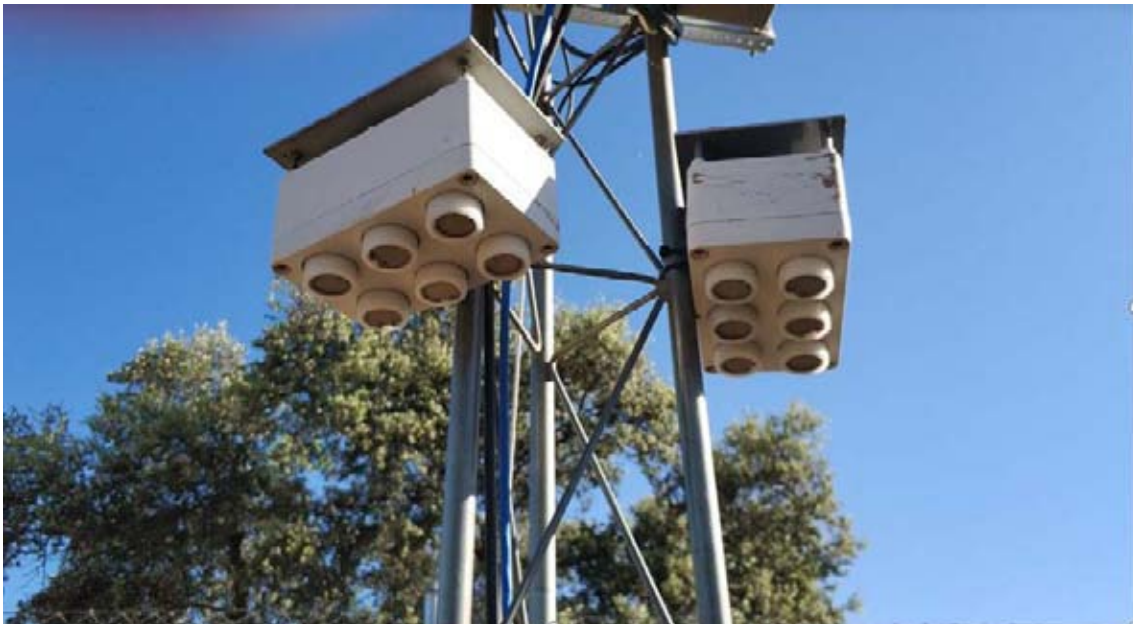
EFE-11. Dosímetros pasivos utilizados en las parcelas de Nivel II del ICP-Forests
