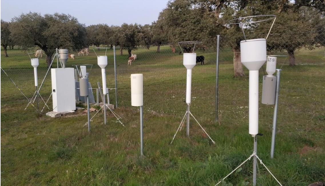
*EFE-10. Colectores de deposición en la estación experimental de Majadas de Tiétar, utilizados para estudiar la deposición de compuestos nitrogenados.*
