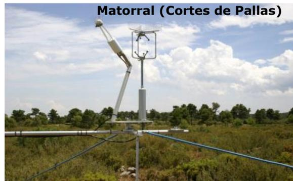
EFE-1. Estaciones de medidas de flujos de  $\text{CO}_2$  y  $\text{H}_2\text{O}$  operadas por la Fundación CEAM.
