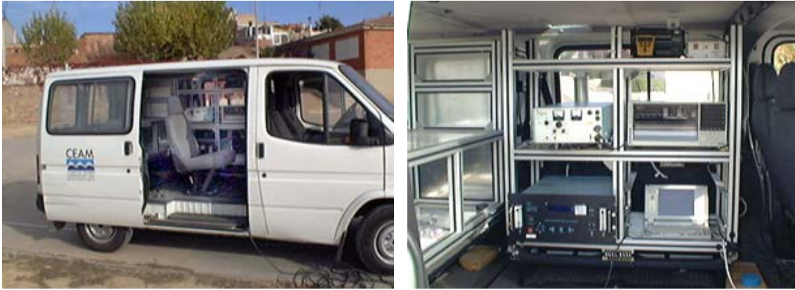
Figura 2. Fotografías de una de las unidades móviles instrumentada con un COSPEC V modificado y configurado para medir \text{NO}_2 . La unidad móvil también está instrumentada con un monitor en continuo de quimioluminiscencia para la determinación de la concentración de \text{NO}_2 y \text{NO}_x en el suelo.
