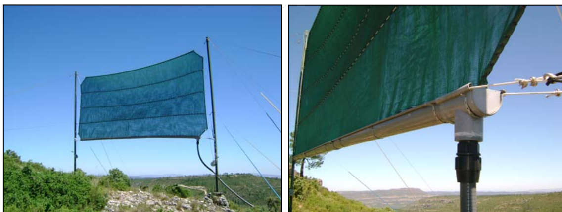
Figura 2: Captador de niebla instalado en el monte Machos (Ayora, Valencia) y detalles del sistema de recolección y conducción del agua
