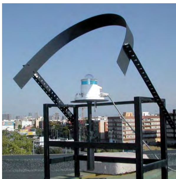
Foto 1. Dispositivo experimental para la medida de la radiación UVER difusa.
