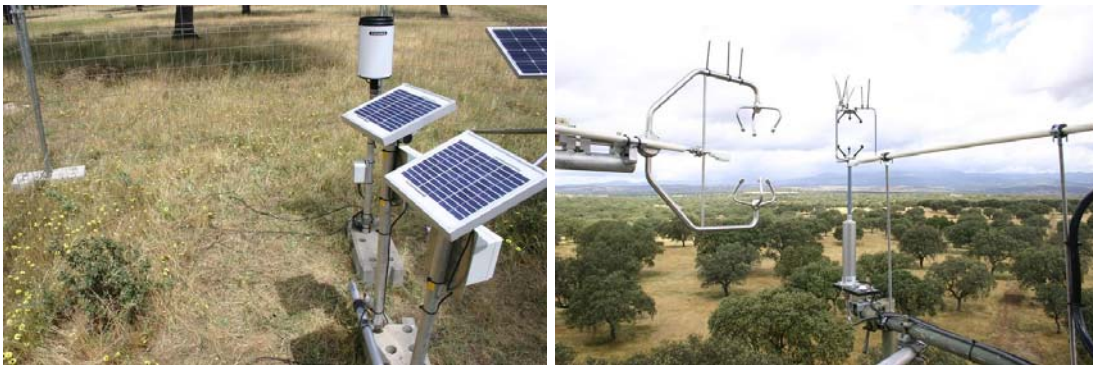
Estación experimental de Majadas del Tietar (Cáceres). Instrumentación autónoma de la Universidad de Amsterdam (VUA) para medidas de precipitación, de temperatura y humedad del suelo y flujo de calor en el suelo, alimentada por sistema solar y controlado por radio (izquierda). Sistema de medidas de flujos de carbono y vapor de agua por “Eddy covariance” de la VUA funcionando en paralelo con un sistema de referencia operado por el CEAM a 15m de altura.
