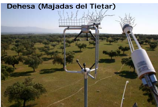
Estaciones de medidas de flujos de CO 2 y H 2 O operadas por la Fundación CEAM. ( http://ceamflux.com )
