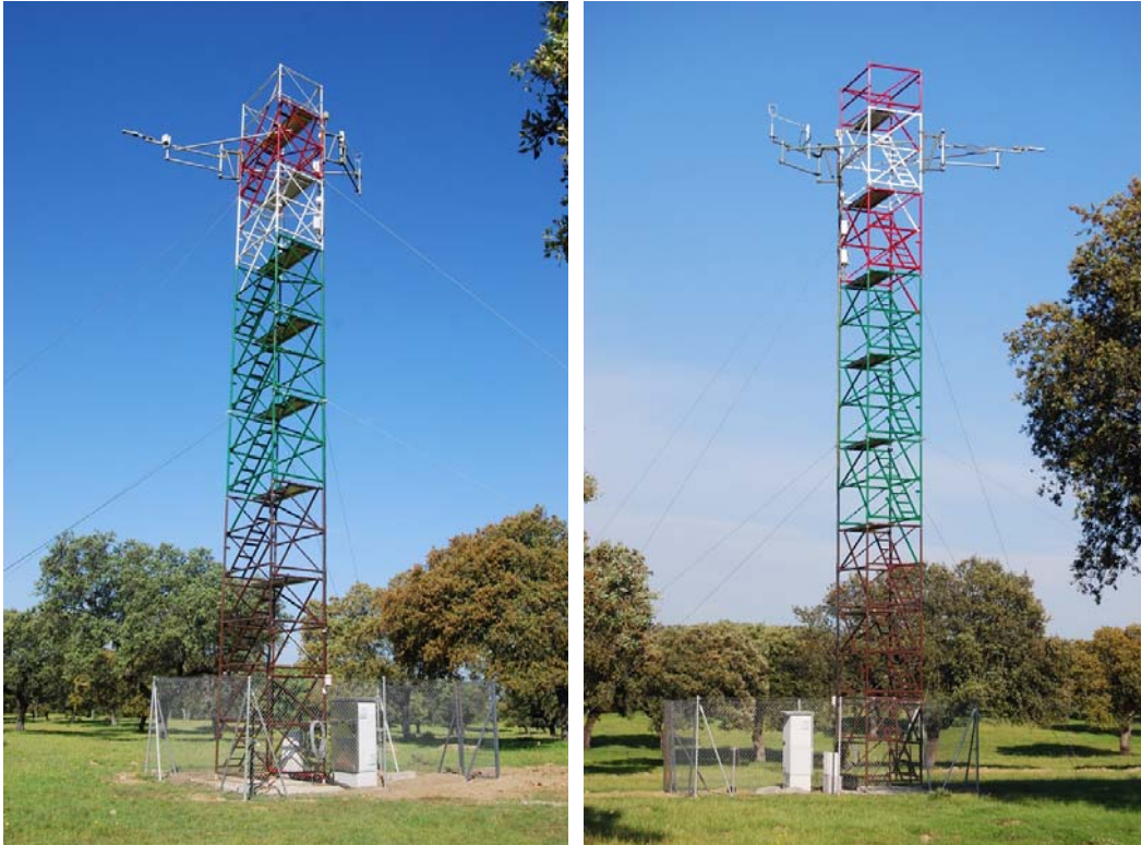
Estación experimental de Majadas del Tietar (Cáceres). Nuevas torres de flujos de carbono y vapor de agua implementadas en Marzo de 2014 en la dehesa boyal de Majadas del Tietar. Torre "Sur" (izquierda) y Torre "Norte" (derecha).
