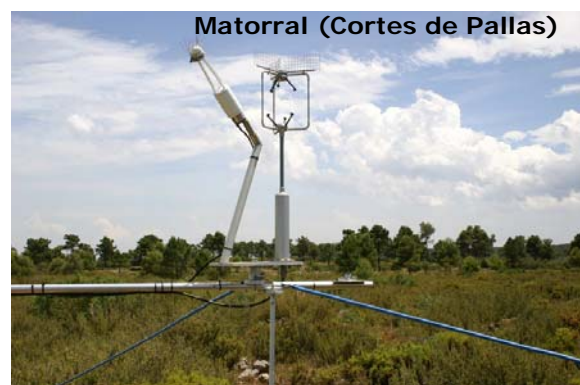
Estaciones de medidas de flujos de CO 2 y H 2 O operadas por la Fundación CEAM. ( http://ceamflux.com )
