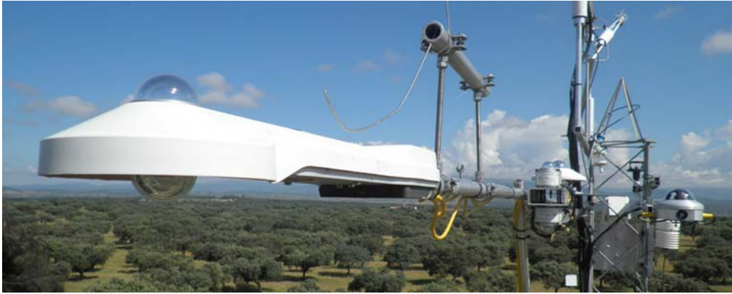
Estación experimental de Majadas del Tietar (Cáceres). Instrumentación para medidas de radiación y de flujos de carbono y vapor de agua.
